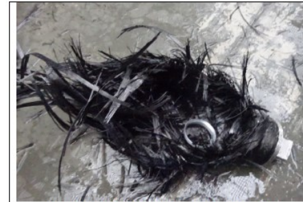
Part 012 700 088 : Burst result 172,3 MPa
